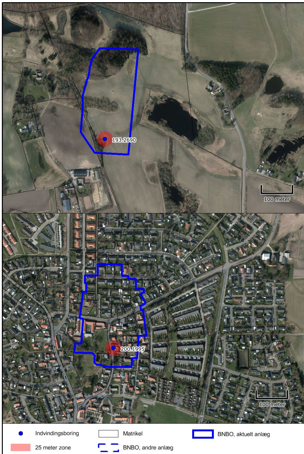
Figur 1. Oversigtskort med zoner og udpegninger ved anlægget.
